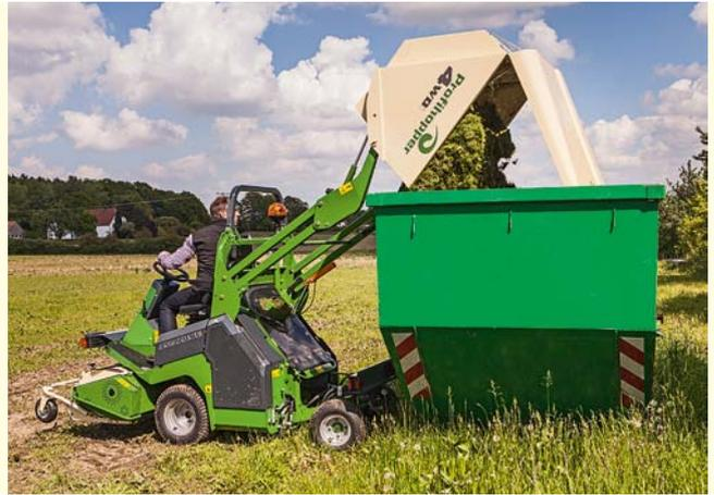
⊕ „Ebenso gelobt wurde die Hochentleerung des Sammelbehälters. Bis zu einer Höhe von 2,1 m kann der Profihopper das Schnittgut damit überladen.“
