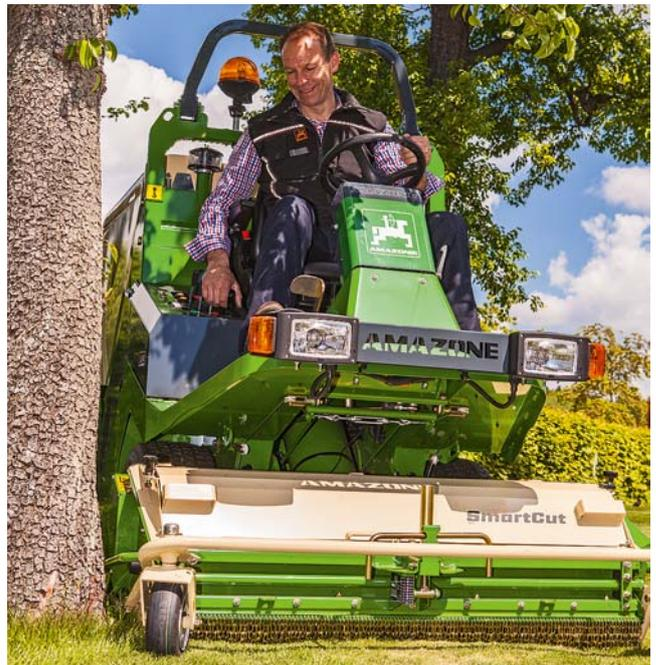
⊕ „Das ist besonders klasse, wenn man um Bäume oder Masten herum mähen muss. Die hydraulisch unterstützte Lenkung funktioniert leichtgängig.“
